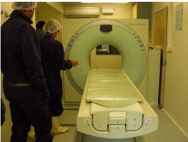
Abb. 4: Fahrbarer MRT zur Klassifizierung lebender und geschlachteter Tiere - hier: LKW-Innenraum
