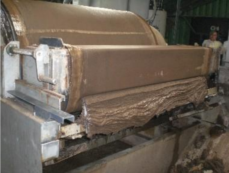
Abb.2: Siebbandpresse zum Auspressen der festen Phase aus der Gülle, woran der Hauptteil des Phosphor gebunden ist
