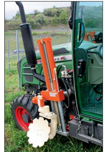
Scheibensech als Zwischenachsgerät in einer Gerätekombination zur Unterstockpflege.
