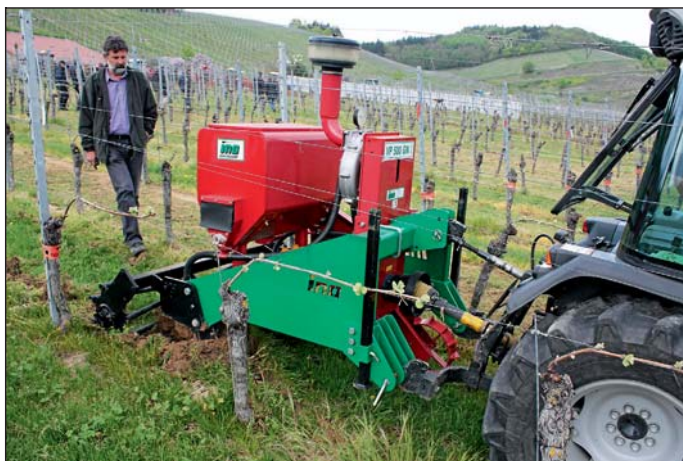
Zweireihiger Vibrationstiefenlockerer mit pneumatischer Düngevorrichtung der slowenischen Firma INO
