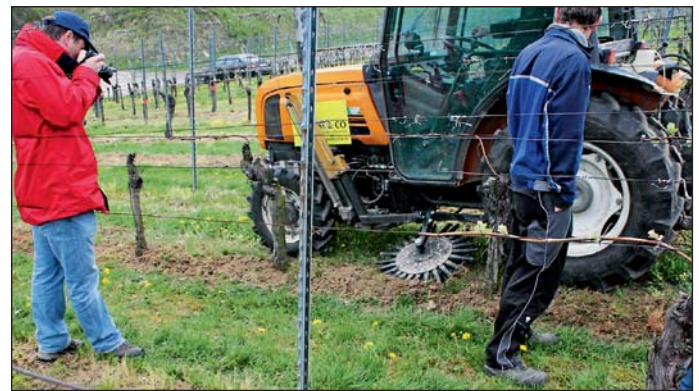
Die Maxi Fingerhacke der Firma Fobro-Kress zupft den Bewuchs unter den Stöcken aus.
