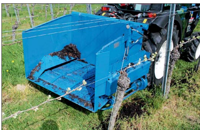
Seitlich angebrachter Dreipunktstreuer zum einfachen Beladen
