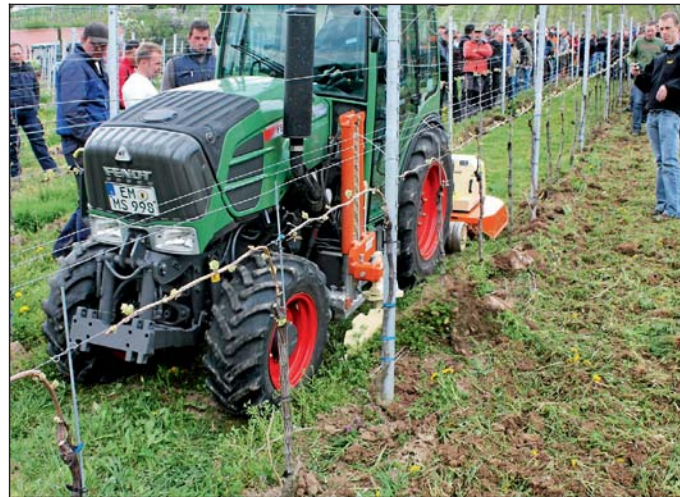
Scheibensech als Zwischenachsgerät in einer Gerätekombination zur Unterstockpflege.
