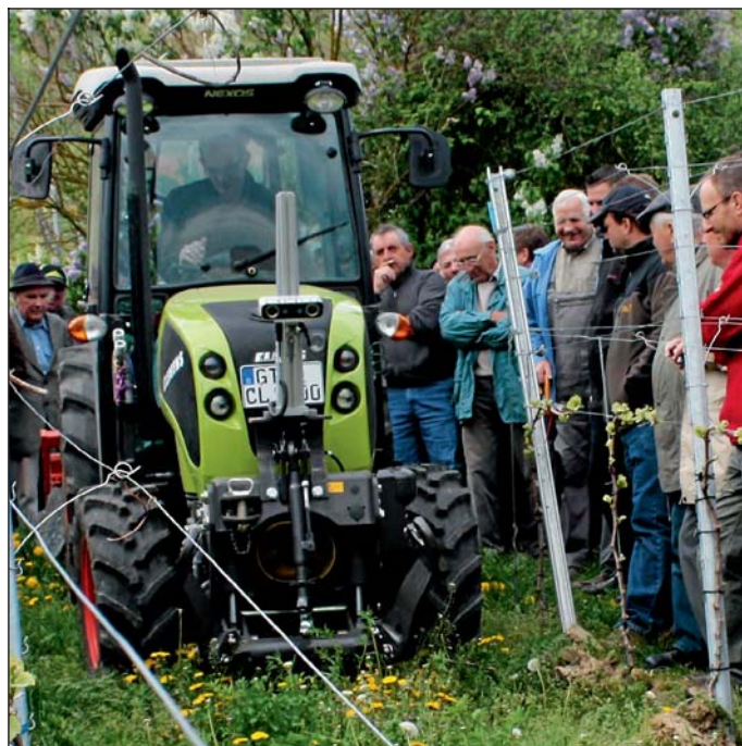
Das automatische Lenksystem Vine Scout der Firma Clemens hält den Schlepper exakt in der Gassenmitte.
