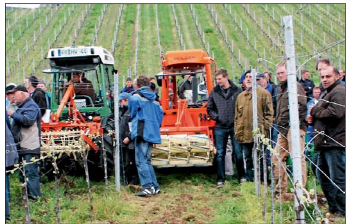
Die Clemens-Walze ECO-Roll und eine Braun-Doppelwalze mit versetzt angebrachten, schräglaufenden Messern zum Walzen der Begrünung
