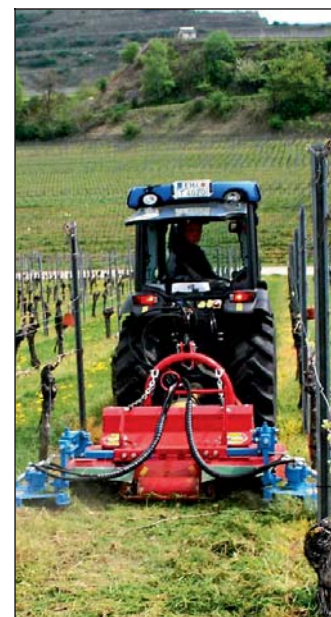
Humus-Gerät LV115 mit zwei hydraulisch angetriebenen Unterstockmulchern
