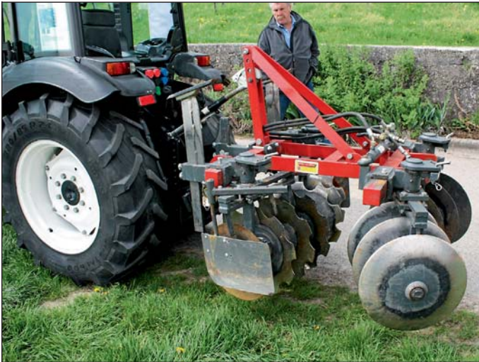
Durch die teilweise gezackten Scheiben der Scheibenpflüge kann der Boden schonend 10 bis 20 cm tief gelockert werden.
