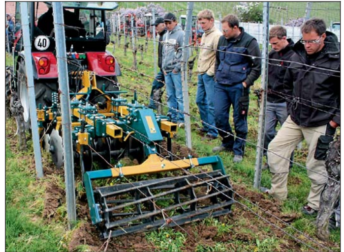
Durch die teilweise gezackten Scheiben der Scheibenpflüge kann der Boden schonend 10 bis 20 cm tief gelockert werden.
