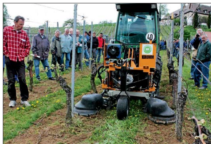
Die Tournesol Unterstockfräse der französischen Firma Pellenc arbeitet und ebnet den Unterstockbereich.
