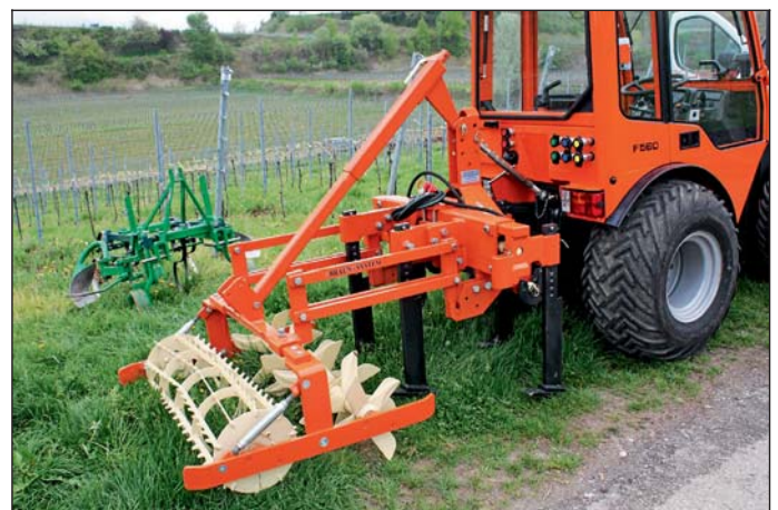
Spatenrolle der Firma Braun im Nachlauf von Grubberzinken zur Vermeidung von Erosionsgräben
