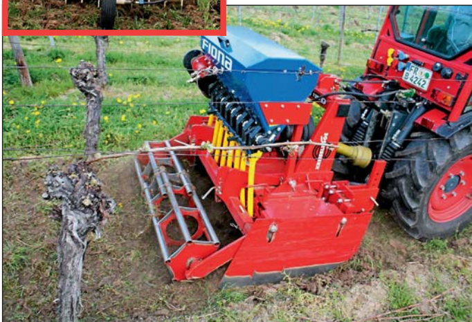
Kombinationen von Kreiseleggen mit Sägeräten für die Begrü- nungseinsaat Bilder: Huber
