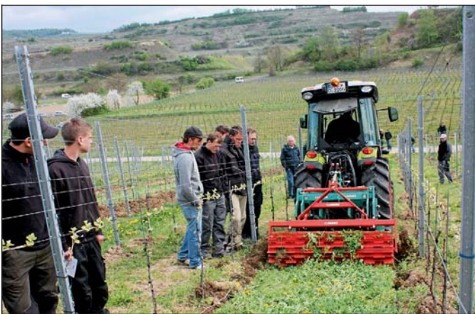
Die Clemens-Walze ECO-Roll und eine Braun-Doppelwalze mit versetzt angebrachten, schräglaufenden Messern zum Walzen der Begrünung
